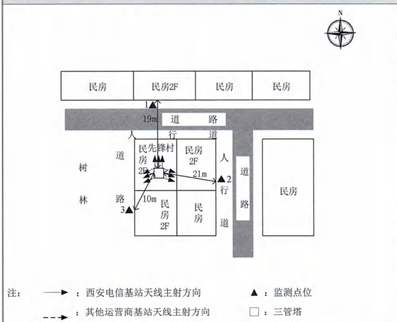
基站电磁辐射环境检测点位示意图
