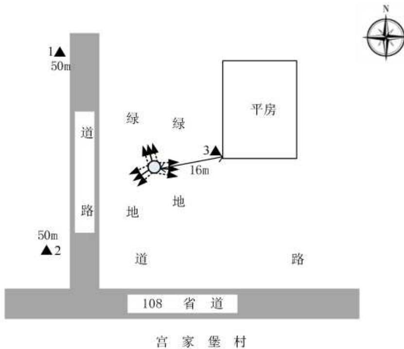
注： ———▶ ：西安电信基站天线主射方向                      ▲ ：监测点位
