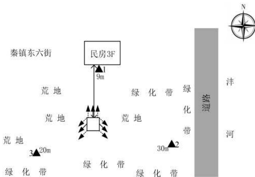
注： —▶：西安电信基站天线主射方向      ▲：监测点位
